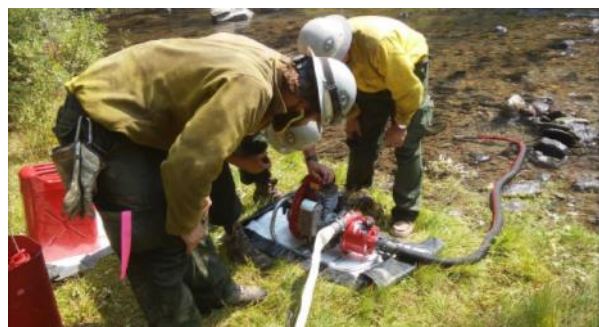
Ajustes de la motobomba para el uso de agua durante las actividades de combate
