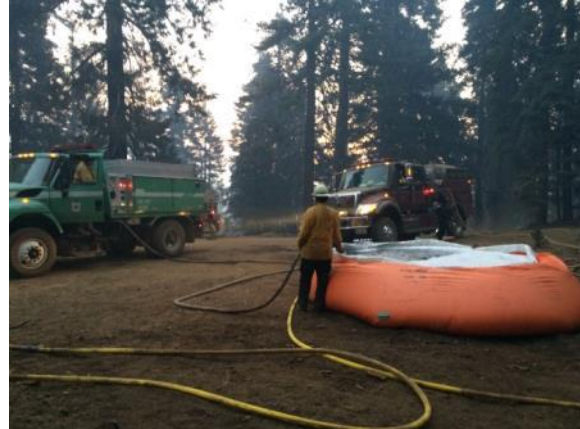
Recarga de agua en Tanques colapsables desde el Carro Motobomba
