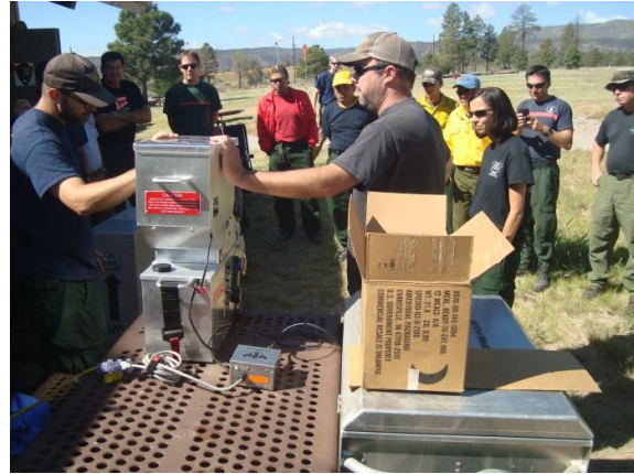
El grupo TREX, observando el funcionamiento de la maquina de pelotas de Ping-Pong, utilizado para quemas prescritas.
