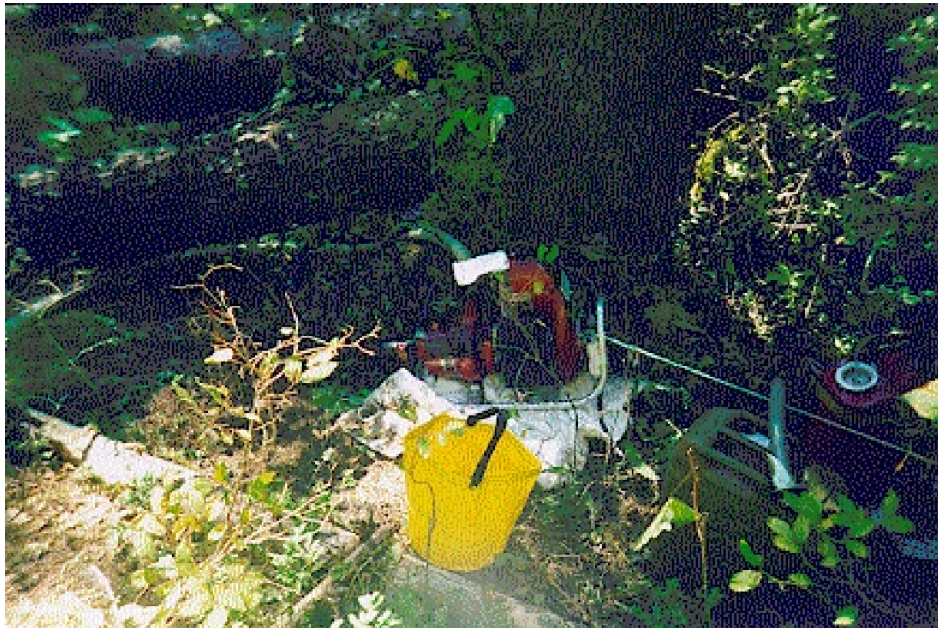
Bomba portátil utilizada para extraer agua de lagos y ríos y realizar labores de supresión.
