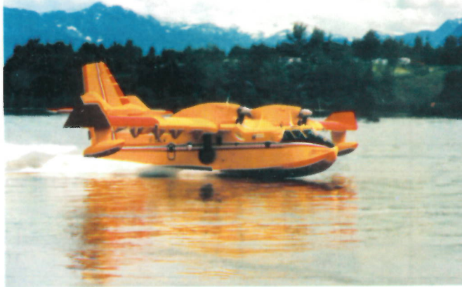
Fig. 8.- Avión anfíbio CL-415 con capacidad de 6,500 lts. de agua utilizado para el control de los incendios en el Ajusco, Tepoztlán, Mariposa Monarca y Ría Lagartos.
