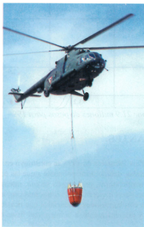
Fig. 9.- Helicóptero MI-8 de la SEDENA con helibalde de 2,500 lts. apoyando en el control de incendios.
