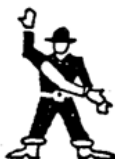
SUELTE EL GANCHO (O LA CARGA) MANO IZQUIERDA HACIA ABAJO Y LEJOS DEL CUERPO, MANO DERECHA HACIA ARRIBA CORTA A TRAVES DEL BRAZO IZQUIERDO CON UN MOVIMIENTO QUE INDIQUE ROMPIMIENTO
