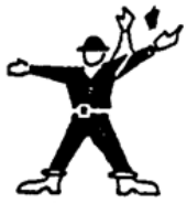
MUEVASE A MI DERECHA EXTENDER BRAZO DERECHO HORIZONTALMENTE Y MOVER LA MANO IZQUIERDA HACIA ARRIBA SOBRE LA CABEZA
