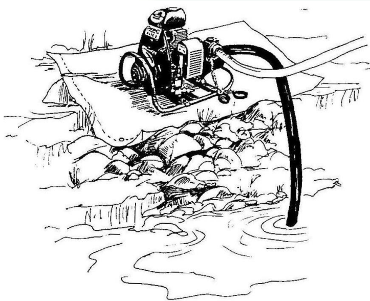
Figura 2. Sitio o lugar de instalación de la bomba.
