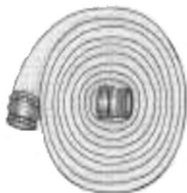
Figura 18. Empaquetado de manguera formando rollo compacto.
