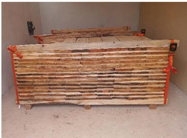
**Imagen 5.** Apilado final de la madera sujeta con cinchos
