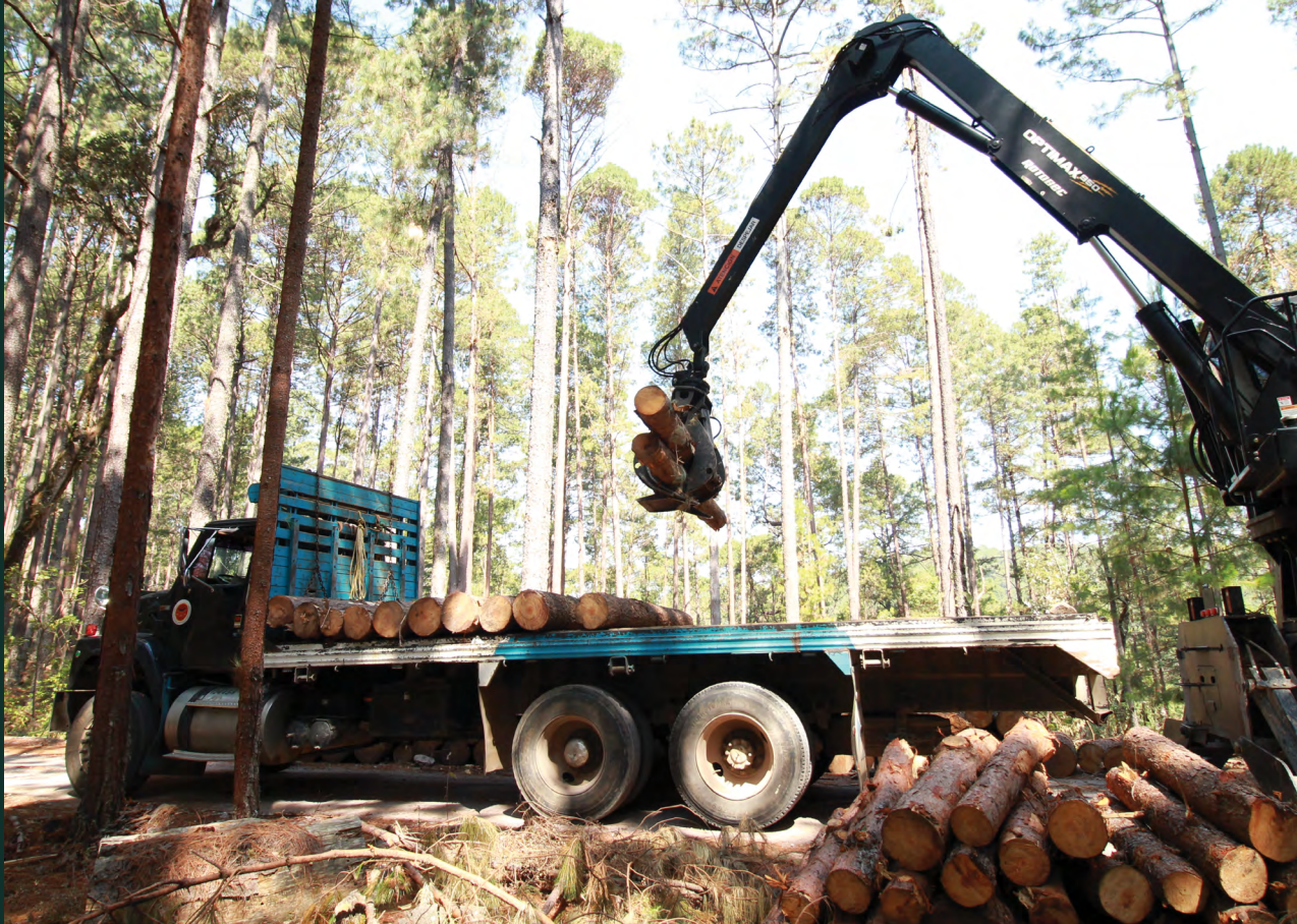
Carga mecanizada de trocería, San Pedro El Alto, Oaxaca.
