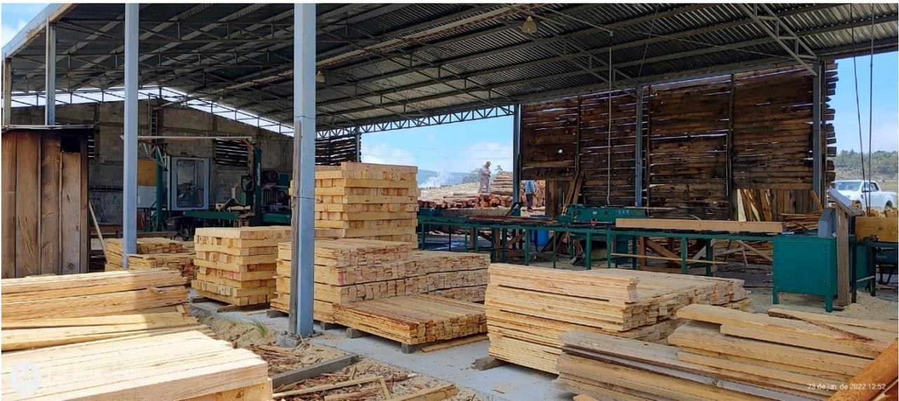
**Fotografía 3.** Madera aserrada de pino, procesada con un aserradero horizontal.
