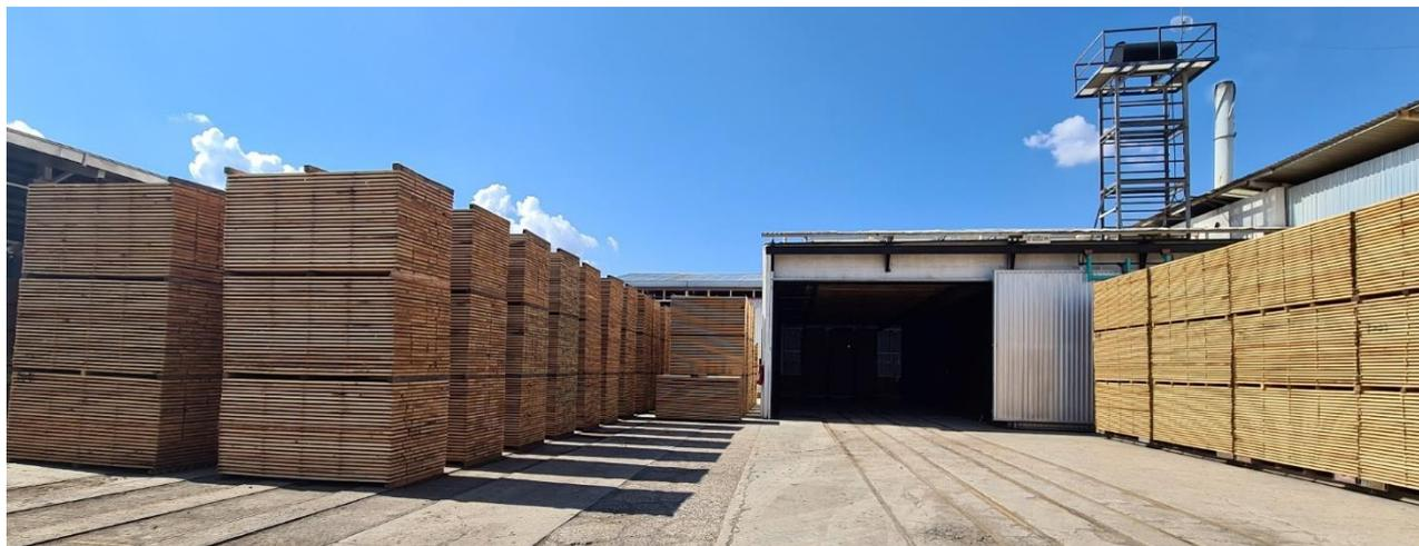
**Fotografía 4.** Estufa de secado para madera aserrada de pino.
